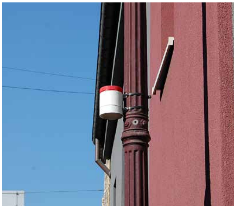
Beispiel eines Passivsammlers für Stickstoffdioxid (NO 2 ) in der Gemeinde Diekirch
